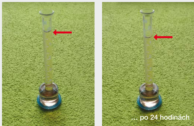
Test nasiakavosti PCI Multiputz® NoBio Z
